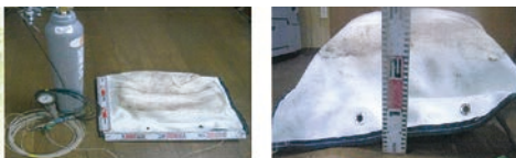
間隔 10cm あれば、セット可能。1枚のジャケットで 30t のリフトアップを実現。壁業ポンペで、コックを開くだけで、ジャケットを膨らませられる。
